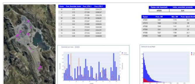
Figura 03: Prototipo local del mapa de eventos de severidad de daños en vías y estadística por cluster y camión del índice de severidad (elaboración propia)
