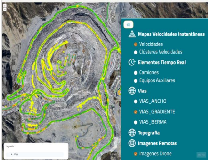
Figura 07: Vista combinada del mapa de calor de velocidad, condiciones geométricas de la gradiente superpuestas a imágenes de dron para una fecha específica.
